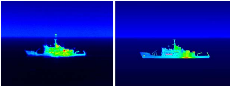
Une image IR des reflets du soleil sur le NAFC Quest et des reflets simulés au moyen du logiciel ShipIR.
