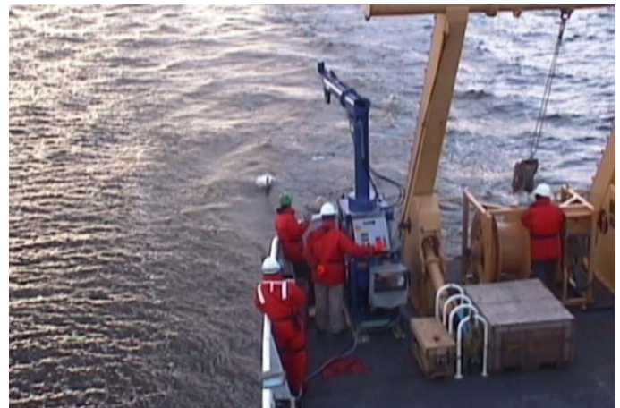
SPCCL remorqué par un MVP200™ sur le navire auxiliaire des Forces canadiennes Quest.
