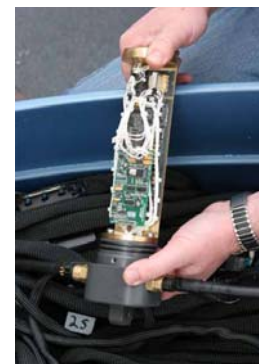
Électronique prototype de faible puissance pour les capteurs à champ électrique sous-marins
