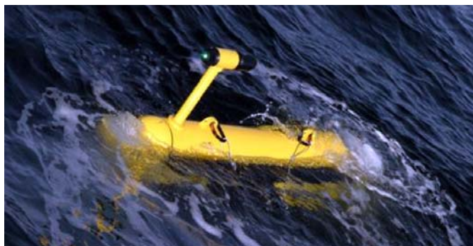
Le v6hicule hybride autonome sous-marin MACO, r6alis6 par RDDC en collaboration avec l'Universit6 de Victoria, associe le mouvement multiaxe stabilis6 avec la mobilit6 dynamique vers l'avant.
